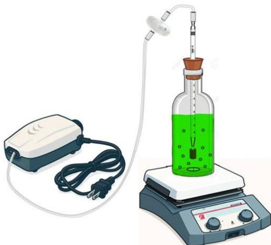
Figura 1. Sistema para la propagación de la microalga; reactor de vidrio de 1 L con difusor de aire, parrilla de calentamiento y bomba de aire.
