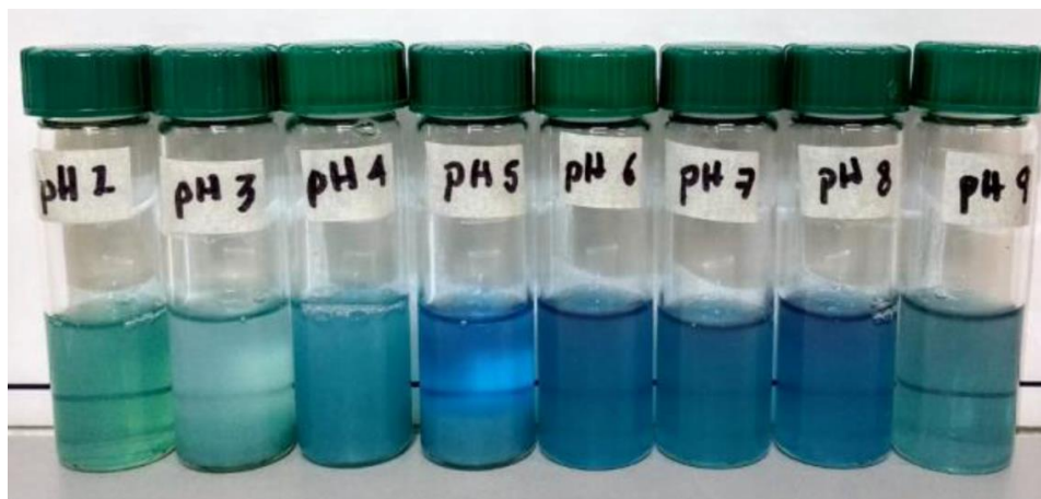
Figura 3: Estabilidad física de las nanodispersiones de C-ficocianina/WPI-pectina a diferentes condiciones de pH
