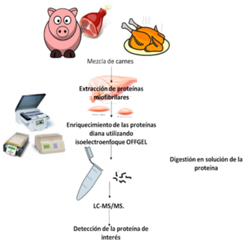
Fig. 2. Aproximación proteómica desarrollada para la detección de la autenticidad de un producto cárnico.
