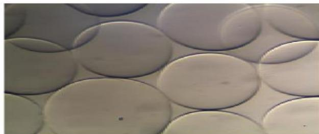
Figura -3 Observación en microscopía óptica de las cápsulas de alginato
