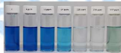
Fig. 1. Efecto de las CuZnONPs en la degradación del colorante azul de metileno
