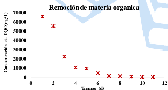
Fig. 1. Remoción de DQO en el tiempo de operación del reactor
