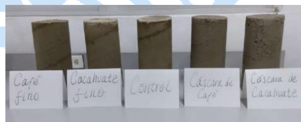
Fig. 1. Cilindros de residuos de café y cacahuate; dos con partícula fina y otros dos con partícula de mayor tamaño.
