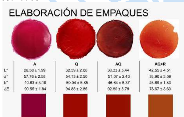
Fig. 1. Elaboración de películas comestibles y sus parámetros de color. A: almidón; Q: Quitosano; R: Aceite esencial de romero.
