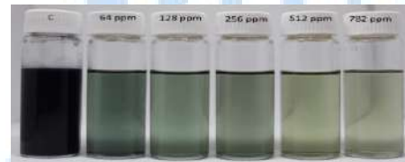
Fig. 2. Efecto de las CuZnONPs en la degradación del efluente textilero
