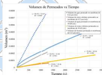
Figura 2. Datos experimentales para caracterizar las resistencias de membranas y tortas en la microfiltración a 0.22 µm para concentración de células; microfiltración de restos celulares a 0.22 µm y ultrafiltración a 30 kDa.
