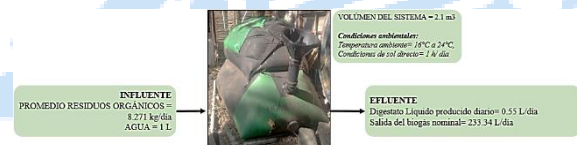
Fig.2. Condiciones de operación Biodigestor Anaeróbico HomeBiogas® en Huerto Roma Verde
