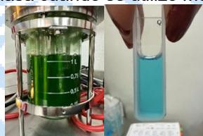
**Fig. 1.** Fotobiorreactor de tanque agitado y ficocianina obtenida.
