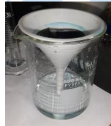
Figura 2. Vista de una solución filtrada a través del carbón activado utilizando H3P04 al 85%
