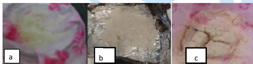
Fig. 1. Quitina y quitosano obtenidos: quitina obtenida con agitación en la desproteinización (a); quitosano obtenido de la quitina anterior (b); quitosano obtenido sin agitación en la desproteinización (c).
