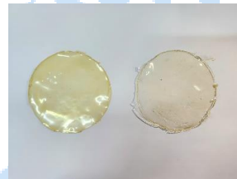
Figura 1. Recubrimientos obtenidos a partir de los dos tipos de quitosano (QF: izquierda; QB: derecha)
