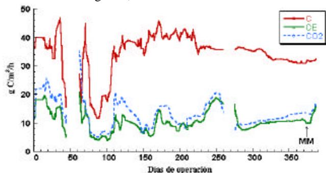
*Fig. 1 Carga, capacidad de eliminación y producción de CO<sub>2</sub>*
