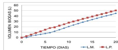
**Fig. 1.** Producción acumulada de biogás en el reactor para influente de lodo mixto crudo (L.M) y mezcla de lodo mixto pretratado (1:2) (L.P.).
