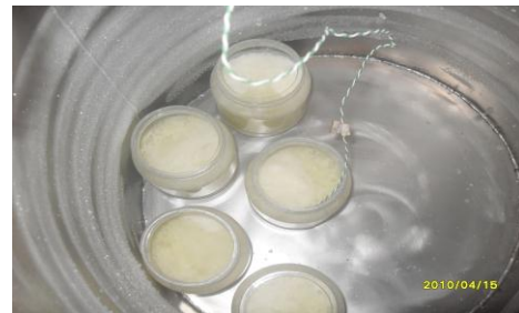
Fig. 1. Liofilización de suero láctico mediante sublimación al vacío a una temperatura de -40^{\circ}\text{C} por un lapso de 8 horas.
