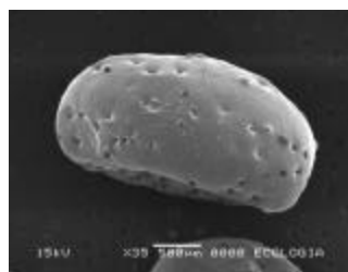
Fotografía en microscopio electrónico de barrido de partícula de HY con biomasa. 35 X
