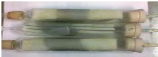
Figura 1. Tubos con placas horizontales de EPU, con flujo continuo de aire humidificado y con temperatura constante. El CO 2 , se determinó en línea por cromatografía.
