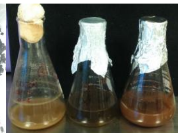
Fig. 2. Cultivos microbianos obtenidos de residuos de cartón, bagazo de caña y cascarilla de coco.
