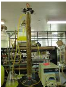
Figura 1. Biorreactor de lecho empacado con roca volcánica (piedra pómez)
