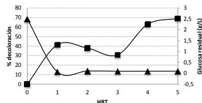
Fig. 1. Comportamiento de la decoloración (■) y consumo de glucosa (▲) en el tiempo para el reactor de 5L.
