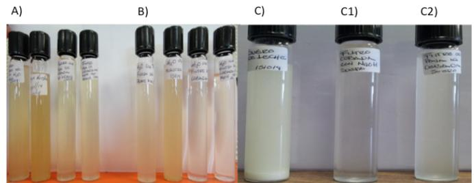
**Figura 2.** Muestras de agua de canal (A), agua de presa (B) y suero láctico (C) obtenidas después de su filtración con los biofiltros orgánicos; muestra de suero (C), suero filtrado con paja de cebada con tratamiento (C1) y suero filtrado con paja de cebada sin tratamiento (C2).
