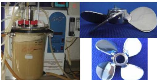
Fig. 1. Biorreactor agitado mecánicamente para la producción de *Steinernema carpocapsae* en cultivo monoxénico sumergido. Se muestra la geometría del impulsor usado.
