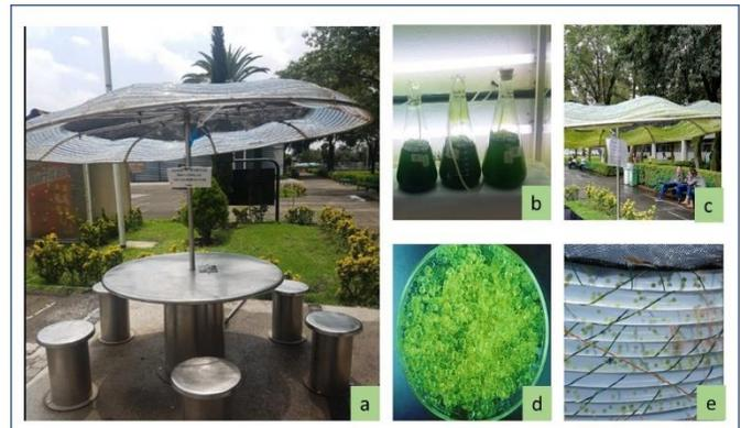
Fig. 2. A. Fotobiorreactor instalado. b y c cultivo libre de la microalga. d y e cultivo inmovilizado en alginate de calcio.
