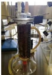
Figura 1. Biorreactor de lecho empacado
